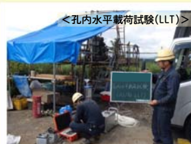
<孔内水平載荷試験(LLT)>
