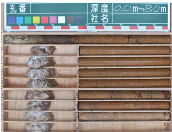
写真-4 コアの一例(火山灰質粘性土)
